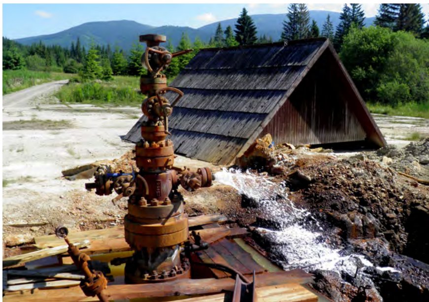
Foto 69. Štruktúrny vrt FPJ-1 (dosiahol hĺbku 2 417 m, Oravská Polhora-Slaná voda, d. b. F273).
