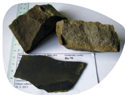
Obr. 3.4-8. Rovnoplochý čiernohnedý laminovaný krehký nevápnitý ílovec a tenkodoskovitý tmavosivohnedý nevápnitý siltovec. Menilitová litofácia. Vpravo hore pieskovec z bázy spodnej pieskovcovo-ílovcovej litofácie [(Handlová-Rázsocha (Remat)].
