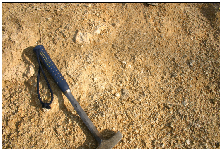
Obr. 3.5.1-9. Arkózové piesky na lokalite Dubové, zložené výlučne z granitoidného materiálu (foto A. Nagy).
