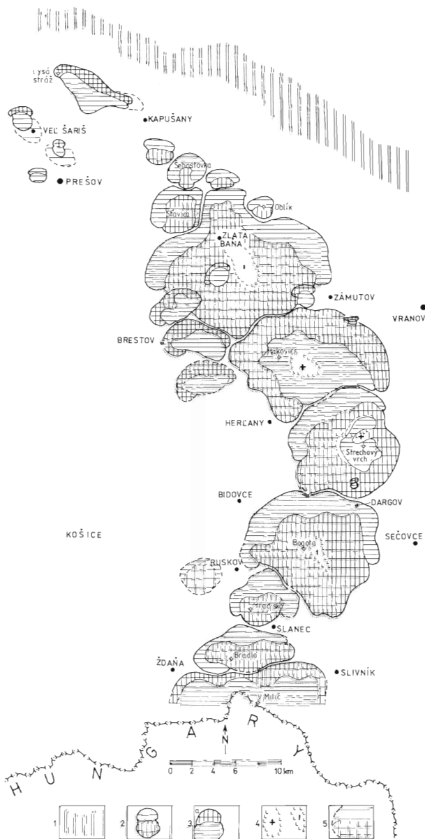
Obr. 2. Magnetická polarizačná schéma Slanských vrchov. 1 – bradlové pásmo, 2 – normálne polarizovaná magneticky anomálna vulkanická štruktúra, 3 – reverzne polarizovaná magneticky anomálna vulkanická štruktúra, 4 – centrálna vulkanická zóna s opačnou polaritou ako plášť vulkánu, 5 – zakryté magneticky anomálne andezitové vulkanity.
