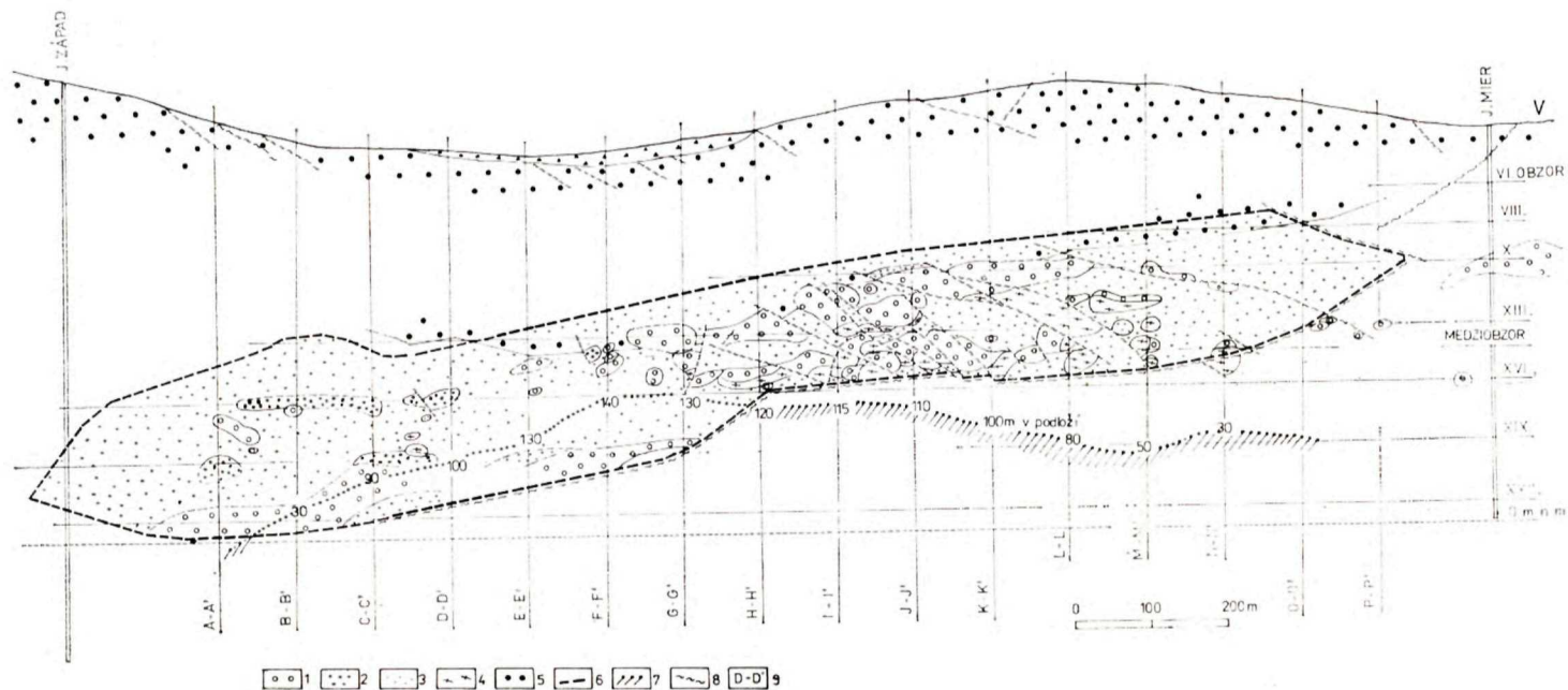
Obr. 3. Priestorová distribúcia tektonickej melanže (priemet do zvislej roviny) a jej vzťah k Nadložnej žile Droždiak a k severnejšie ležiacemu diapírovo vztýčenému okraju rulovo-amfibolitového telesa. 1—5 vysvetlivky ako na obr. 2, 6 — hranica vývoja Nadložnej žily Droždiak, 7 — priemet vrcholovej línie diapíru s vyznačením jej horizontálnych vzdialeností od na J ležiacej zóny budín, 8 — mladá dislokačná tektonika, 9 — lokalizácia S—J orientovaných profilov.
