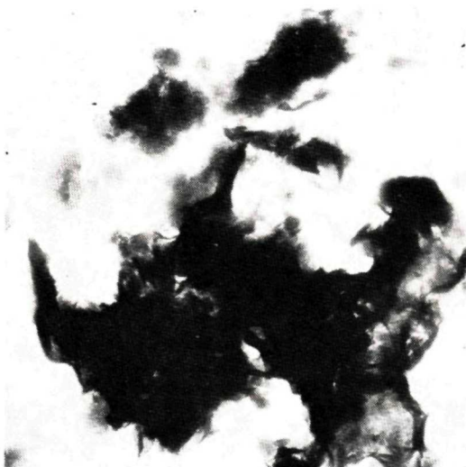
Obr. 6. Montmorillonit. Zóna intenzívnej premeny. Suspenzia, zväčš. 14 000x
