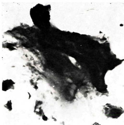
Obr. 4. Postupný rozpad častice vulkanického skla, zóna menej intenzívnej premeny. Suspenzia, zväčš. 5600x
