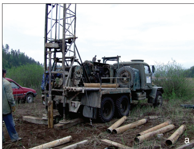
Obr. 2. a – Vzorkovanie odkaliskových sedimentov na odkalisku Markušovce; b – Povrchové výnosy strusky pochádzajúcej z Kovohút Krompachy, ktoré sú uložené na povrchu odkaliska Slovinky.
