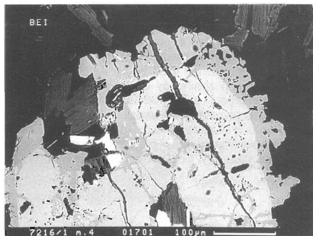
Obr. 8. Skanová kompozícia predalpínskeho granátu almandínovo-spessartínovo-pyropového zloženia vyhovujúceho sivou, o grossulár obohatenou fázou (vz. 7216/1, tab. 4). Tmavosivá fáza je biotit (tab. 2).
