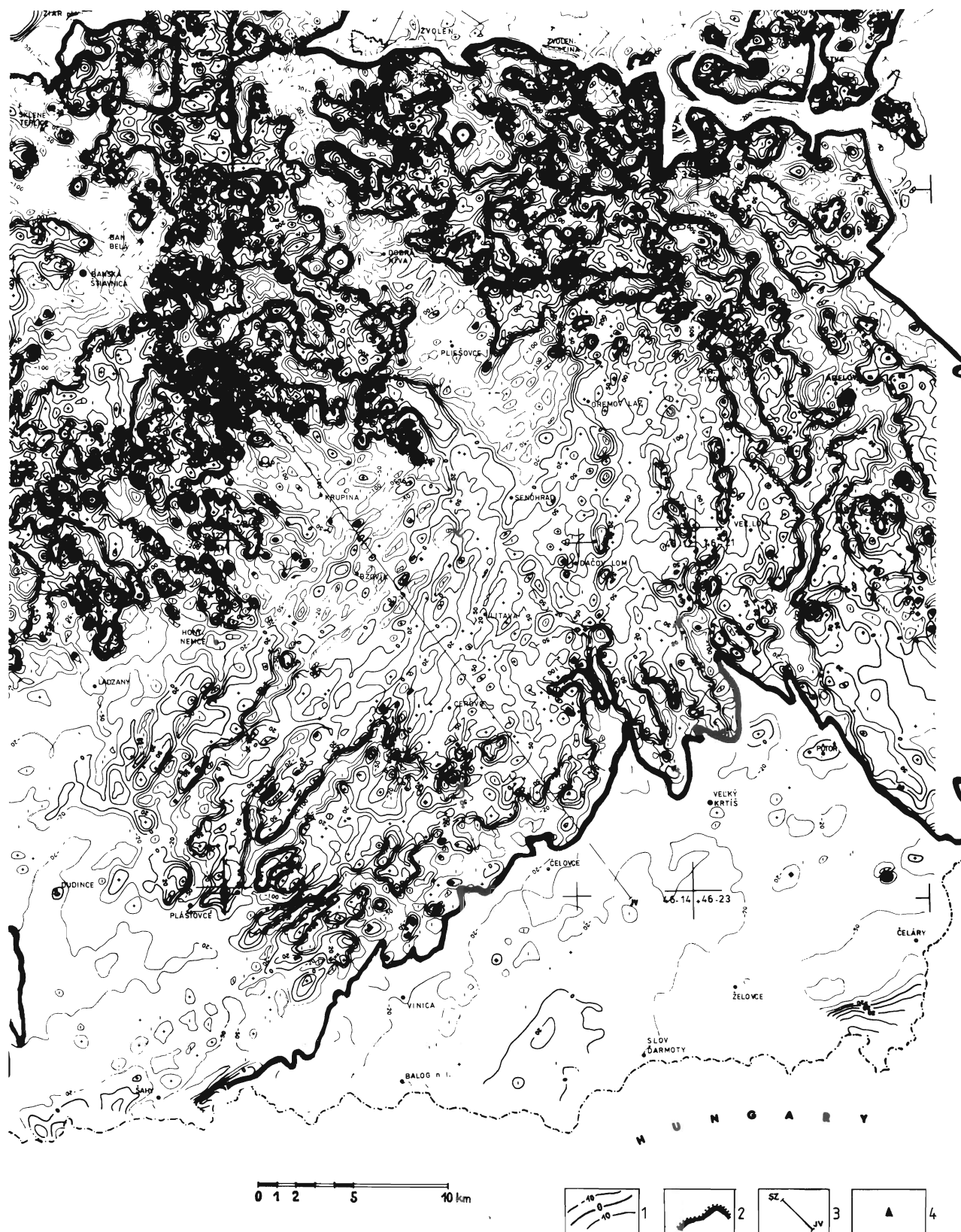
Obr. 1. Aeromagnetická mapa Krupinské planiny pořízená ze základní letové výšky 80 m nad terénem (Gnojek a Mutlová, 1987). Fig. 1. Aeromagnetic map of the Krupinská planina Highland at 80 m flight altitude (Gnojek and Mutlová, 1987).
