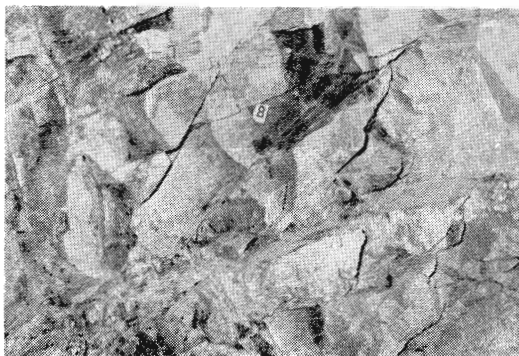
Obr. 7. Vývoj vrásavej štruktúry hornín plášťa v úseku smernej chodby (tektonogram 6) Fig. 7. Development of the fold structure of the mantle rocks in a part of gallery (fabric diagram 6)
