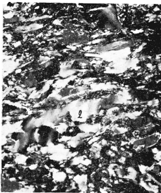
Obr. 5. Diaftoritický chloriticko-muskovitický svor: zvyšky regionálneho a ultrametamorfického kremeňa (q) a plagioklasu (pl) v diaftoritickej mezostáze z drobnozrnného kremeňa, chloritu (chl) a muskovitu (mu). Lepidogranoblasticko-diaftoritická štruktúra. Predná dolina. Zväčš. 28 \times , nik. X
