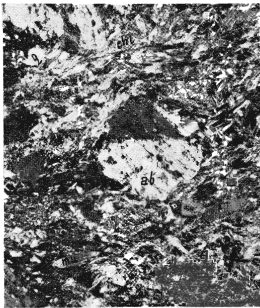
Obr. 6. Diaftoritický chloriticko-muskovitický svor s porfyroblastmi albitu (ab) s chloritom (chl), muskovitom (mu) a kremeňom (q). Porfyroblasticko-granolepidoblastická štruktúra. 1 km na JV od kóty Holého hrbka (677,7). Zväčš. 28 \times , nik. X
