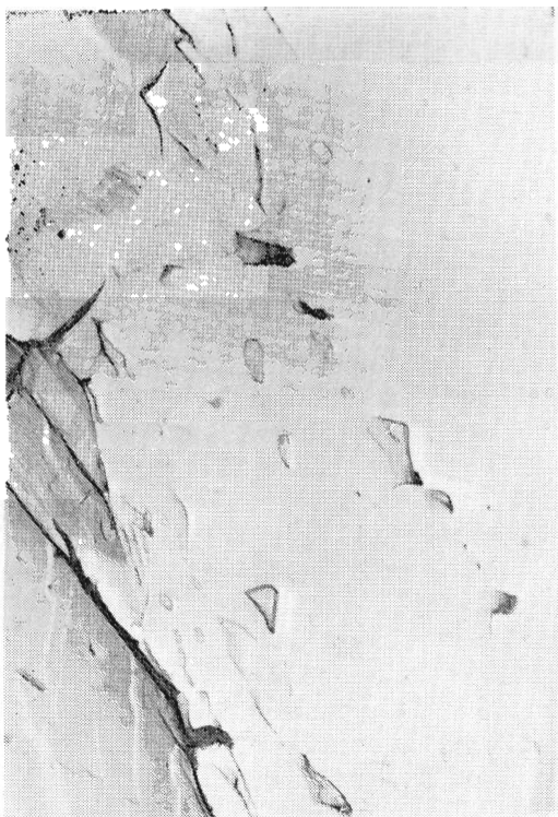
Obr. 7. Mikroštruktúra antimonitu, sčasti bloková, porušená, bez inklúzií (vľavo), s výskytom početných mikroinklúzií rozmerov menších ako 1 mikrometer, ktoré sa miestami zhlukujú do refazcov. Pezinok (Malé Karpaty, vzorka č. 2). Zväčš. 8000-krát. Fig. 7. Microtexture of antimonite, partly block-like, disturbed, without inclusions (left side) and with frequent microinclusions lesser than 1 \mu\text{m} grouping into chains. Pezinok locality, Malé Karpaty Mts., sample No. 2. Magn. \times 8000 .
