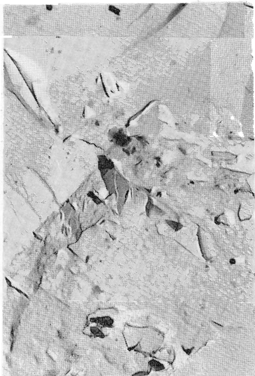
Obr. 3. Bloková mierne porušená mikroštruktúra antimonitu s množstvom mikroinklúzií. Uprostred základnej hmoty antimonitu sú viditeľné zhluky Pb-sulfosolí nepravidelných tvarov. Elektrónová mikrofotografia ukazuje, že v detailoch prebieha proces zámény Pb-sulfosolí za antimonit. Chyžné (Spišsko-gemerské rudohorie, vzorka č. 68). Zväčš. 10 000-krát
