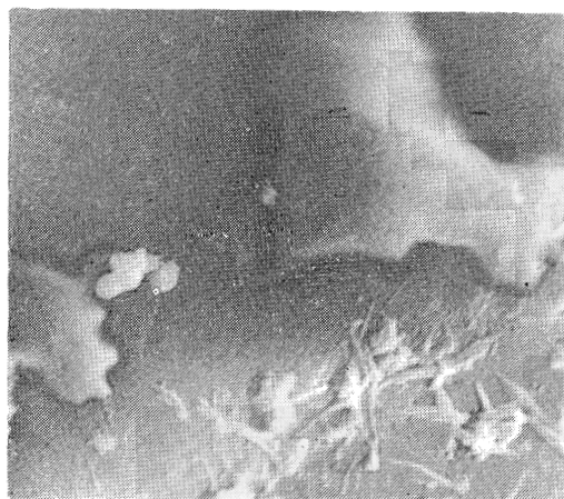
Obr. 13. Uzavrenny cudzích fáz v drahom opáli. Lomová plocha. Rastrovací, elektrónový mikroskop, zv. 12 000 \times
