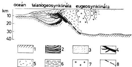
Obr. 2. — Schéma talasogeosynklinály podle N. A. Bogdanova (1969, obr. 3). 1 — bazaltová vrstva, 2 — křemitovulkanogenní formace, 3 — droby franciscanské formace, 4 — flyšová formace, 5 — ultrabazity, 6 — „metamorfní“ vrstva a mělkovodní sedimenty, 7 — granity, 8 — tektonický šev.
