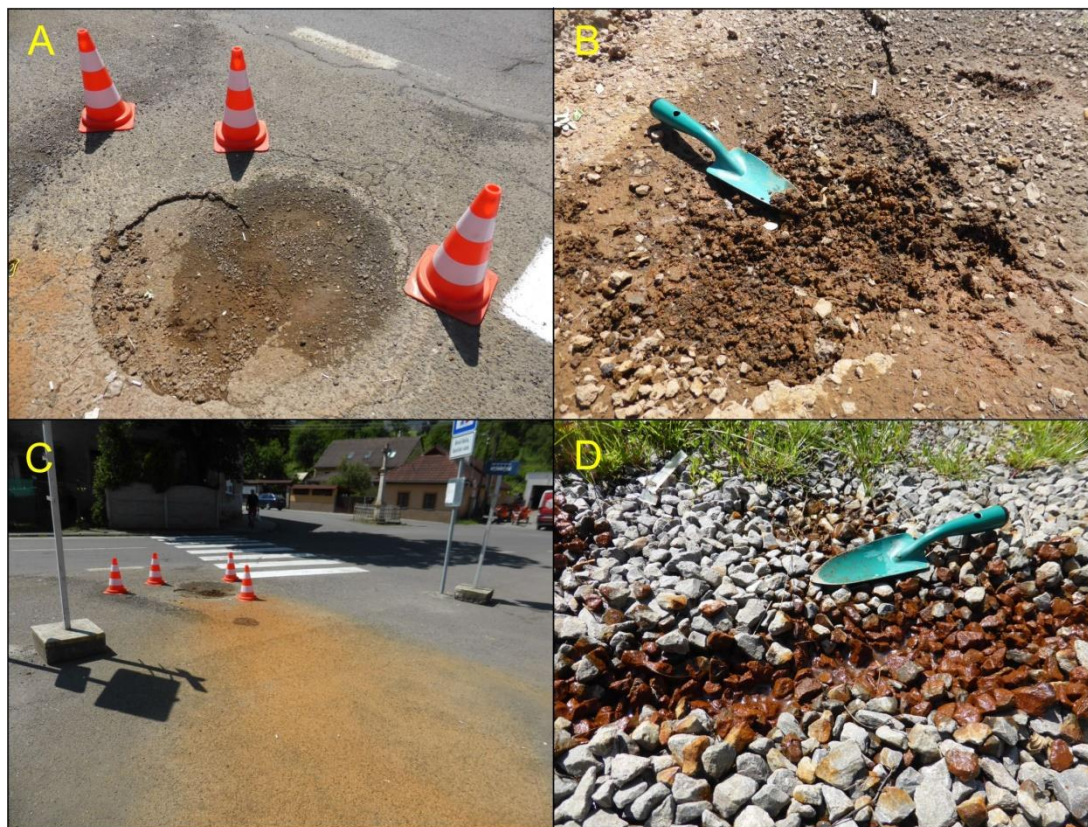
Obr. 2 Prepadnutie povrchu námestia a stopy po pretekajúcich banských vodách zvýraznených kontamináciou FeOOH . B a D - Vzorkovanie precipitovanej fázy FeOOH s obsahom identifikovaného As a Zn.
