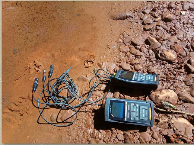
Meranie fyzikálno-chemických parametrov sedimentu v rieke Slaná (foto: I. Györög)
