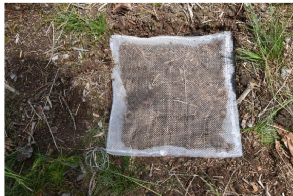
Obr. 3 Sáček se směsí horizontů FH o velikosti 25x25 cm založeného rozkladového („litter bag“) experimentu.
