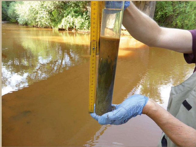
Meranie hrúbky okrového sedimentu rieky Slaná na lokalite Nižná Slaná (foto: I. Stríček)
