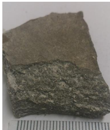
Obr. 1: Kúsok strešnej krytiny – eternitu na lome
