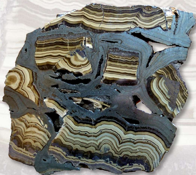
Breccie páskovaných fragmentov so sfaleritom a galenitom, tmelené markazitom. Ložisko MVT, Pomorzany, Poľsko. Vzorku poskytol Adam Piestrzyński. (foto: J. Majzlan)
