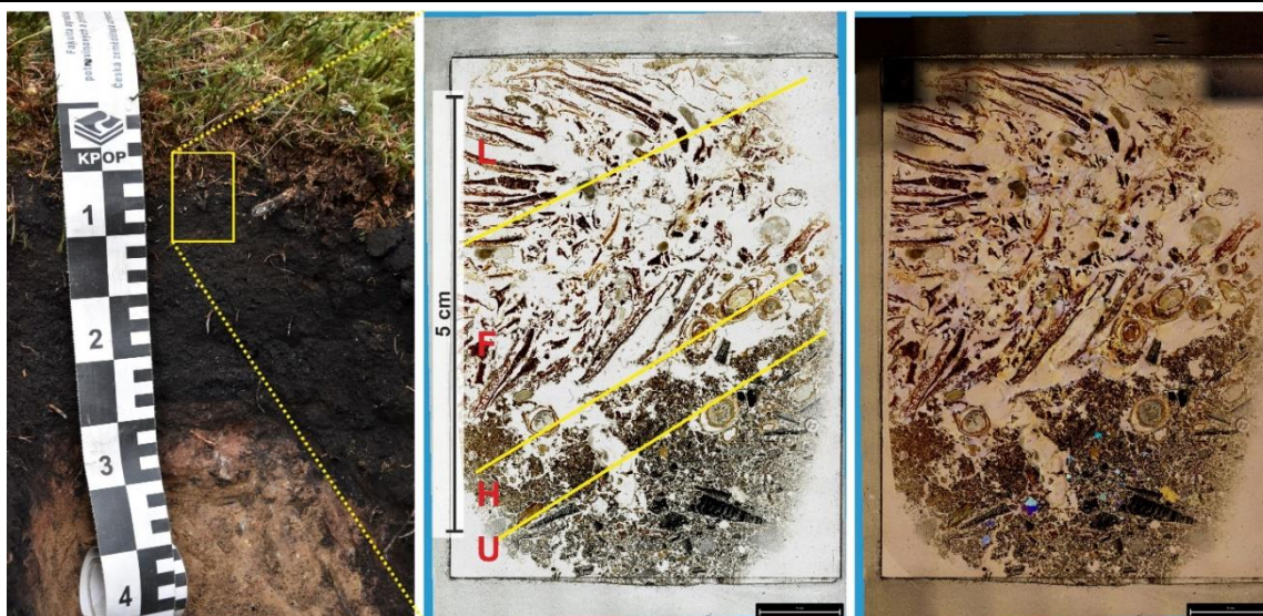
Obr. 2 Přechod organických horizontů (opad, dřev a měl – L, F, H) a antropogenního uhelného (U) horizontu v procházejícím světle (PPL, uprostřed) a se zkříženými nikoly (XPL, vpravo) na milířišti v Českém lese.
