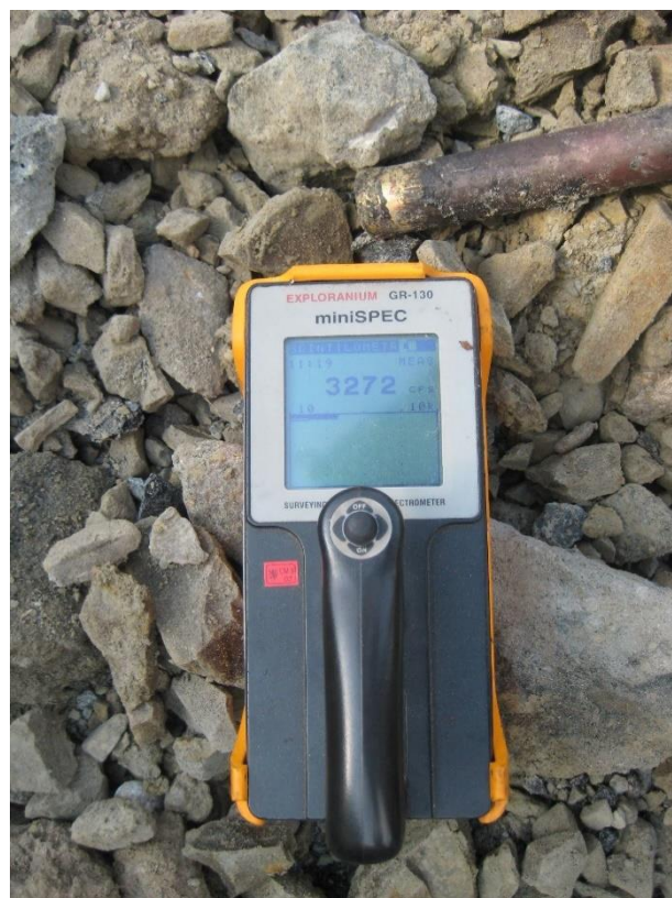
Obr. 4 Mosazná trubka se zářičem – 3\,272 \mu\text{Gy}\cdot\text{h}^{-1}
