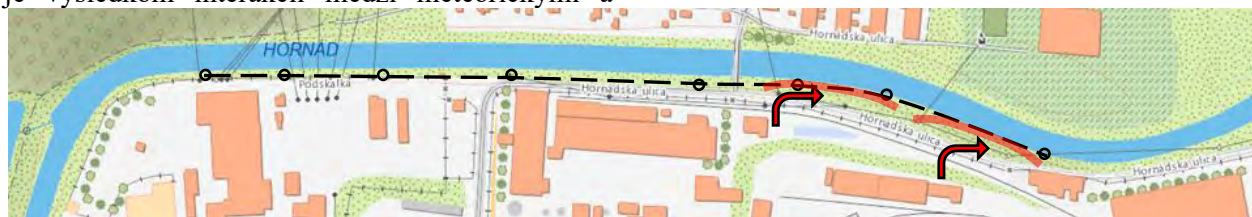
Obr. 1 Priebeh vzorkovaného profilu “ - - -” na severnej strane priemyselného areálu Kovohuty Krompachy situovaného na brehu rieky Hornád. Pozícia profilu kopíruje priestor EZ v kontakte s recipientom Hornádu. Symboly → znázorňujú identifikované toky aktívneho transportu kontaminácie z priestoru EZ do Hornádu. Červenou sú zvýraznené kontaminované zóny technozeme so zachytenou kontamináciou na aktívnej pôdnej geochemickej bariére.
