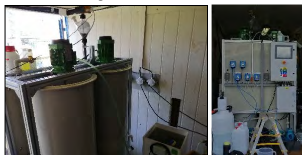
Obr. 3 Zadní část reaktoru s reakční a neutralizační nádobou (vlevo) a přední část reaktoru s dávkovacími čerpadly a ovládacím panelem (vpravo)
