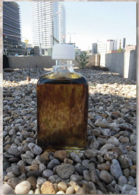
Vzorkovanie podzemných vôd s fázou ropných látok (monitorovací vrt ŠGÚDŠ, križovatka Košická a Pribinova ul., foto L. Jurkovič)
