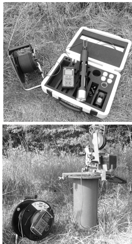
Obr. 2 Řízené spouštění multiparametrové sondy do hydrogeologických vrtů
