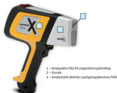
Obr. 2 Prvkový analyzátoři DELTA a jeho popis
