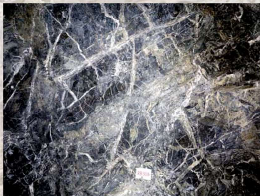
Hustý žilník (kremeň, karbonáty, polymetalické sulfidy) z podložia Karolína žily na drahokovovo polymetalickom ložisku na Rozália bani v Hodruši. Hostiteľská hornina andezit je nehomogénne alterovaná adularizáciou a sericitizáciou, lokálne s hojným chloritom a epidotom (foto – Peter Kodéra).
