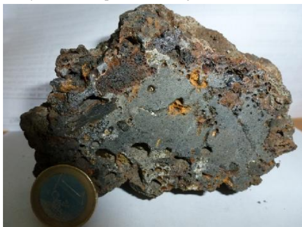
Obr. 2 Pohľad do vnútra rozpílenej trosky skládkovanej na odkalisku v Lintichu. Meteorická voda infiltrovaná cez otvorený priestor pórov spôsobila rozpúšťanie Pb, Zn, Cu sulfidov za vzniku roztoku H_2SO_4 a následne celkovej alterácie silikátovej trosky. Dekompozícia metastabilného silikátového skla a sulfidov uvoľňuje kationy Pb, Zn, Cu, As alej do prostredia.
