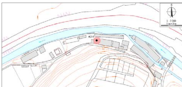
Obr. 1 Lokalita A – mapa areálu s aplikacním vrtem AV-1 ve zdrojové oblasti kontaminace
