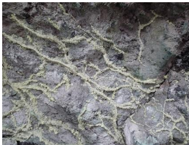
Obr. 4 Precipitácia CaCO_3 (aragonitu), ktorý vzniká po as prirodzenej cementácii haldy odpadu uhlíčitánmi z perkolujúcich vôd infiltrujúcich pórový a puklinový priestor haldy. Vznikajúca uhličitánová krusta pôsobí ako pufer voči hypergénnym reakciám rozpúšťajúcim nestabilný reaktívny syntetický odpad.
