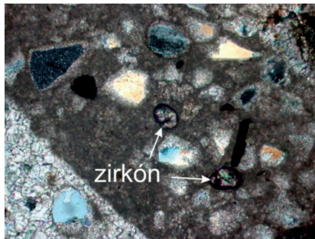
Obr. 4 Organodetritický vápenec s oválnymi klastami zirkónu a s ostrohrannými klastami kremeňa a albitu.
