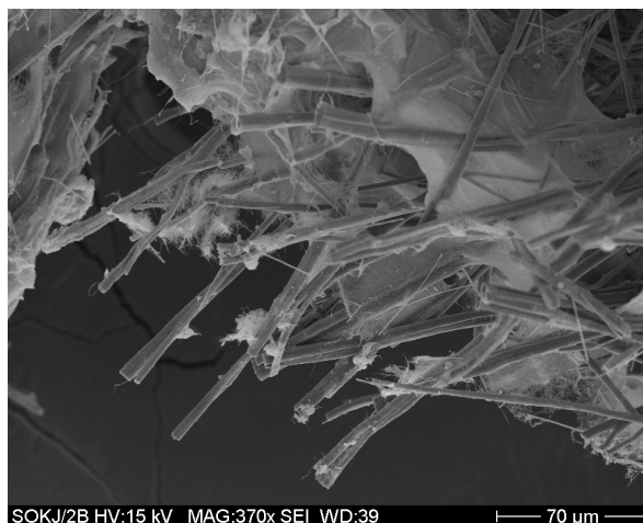
Obr. 2 Vláknité kryštály CaCO 3 na snímke zo skenovacieho elektrónového mikroskopu
