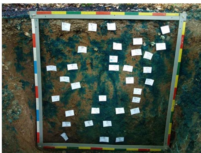
Obr. 2 Odkrytý pôdny profil po aplikácii farbiva
