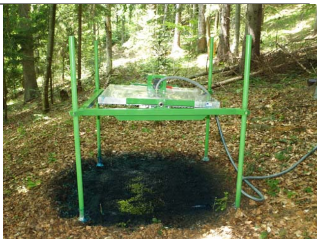
Obr. 1 Aplikácia indikátorového farbiva na pôdu
