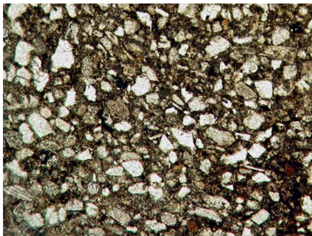
Obr. 2 Siliciklastický detrit v piesčitom bioklastickom vápenci.
