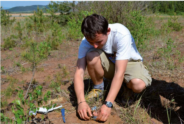
Inštalácia lyzimetrov na odber pórovej vody (odkalisko Rudňany) (foto: K. Peťková)
