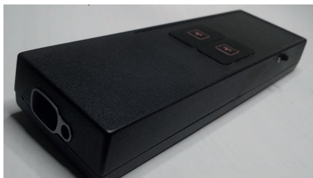
Obr. 98. Vytvorené zariadenie na meranie vzdialenosti, uhlov a GNSS
