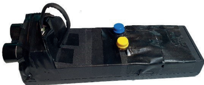
Obr. 119. Prototyp č. 2. V hornej časti sa nachádza LidarLite.
