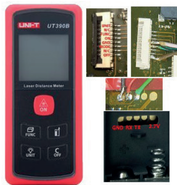
Obr. 95. Laserový diaľkomer UT390B so zobrazením kontaktov na pripojenie sériovej komunikácie (GND-TX-RX) a pripojenie klávesnice zariadenia (ON-GND-OFF)
