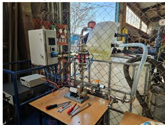
Obr. 1 Pilotný test úpravy surovej vody pred RO
