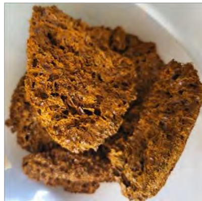
Obr. 1 Sekundárny minerál schwertmannit, detail s jeho pórovitou štruktúrou
