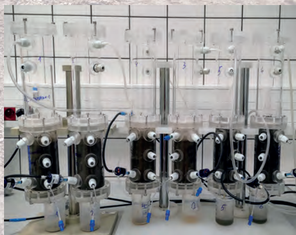
Kolónový experiment testovania biouhľia pri zachytávaní vody a pôdných plynov (foto: M. Vítková)
