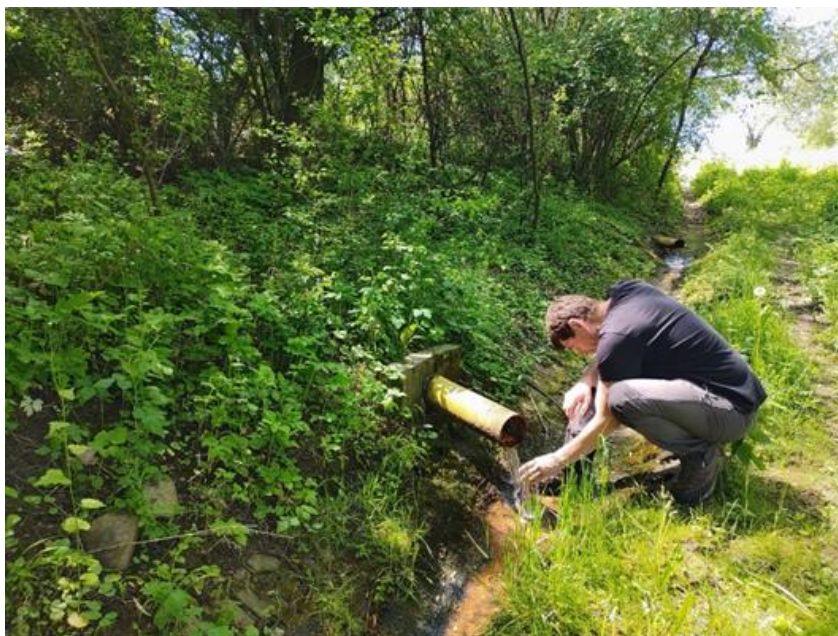
Meranie výdatnosti subhorizontálneho odvodňovacieho vrtu VV-109 na lokalite Veľká Čausa
