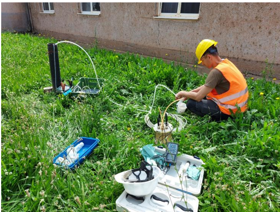
Terénne merania a odber vzorky podzemnej vody na chemickú analýzu z vrtu VN335-3 dňa 18.6.2024 (Nová Baňa – areál bývalých Závodov technického skla)
