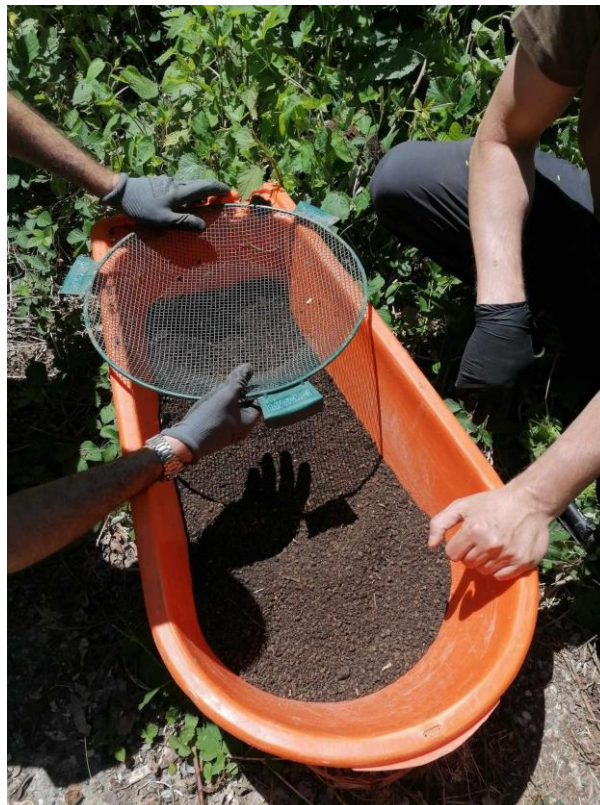
Obder vzoriek riečného sedimentu a pôdy z lokality Strážske. Vľavo: Potok, z ktorého sa odoberal riečný sediment - oblasť “pod prameňom”; vpravo: preosievanie kompozitnej vzorky pôdy.
