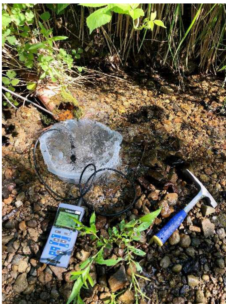
R. Dugovič: Meranie parametrov podzemnej vody
