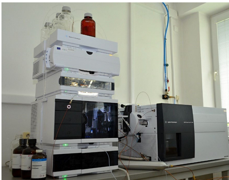
Kvapalinový chromatograf 1260 Infinity II System s hmotnostným detektorom 6470 Tripple Quadrupole Mass Spectrometer, Agilent Technologies.
