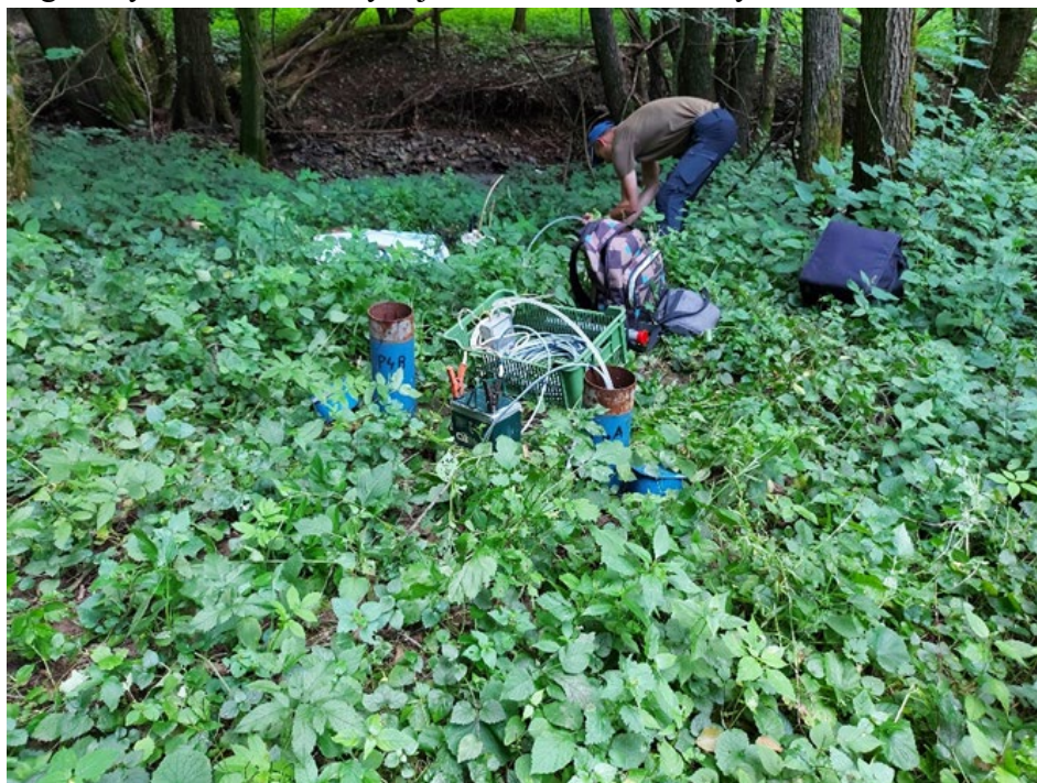
Terénne merania a odber vzorky podzemnej vody na chemickú analýzu z vrtnov VN254-7 a VN254-8 dňa 18.6.2024 (lokalita Pukanec – skládka kalov Hampoch)
