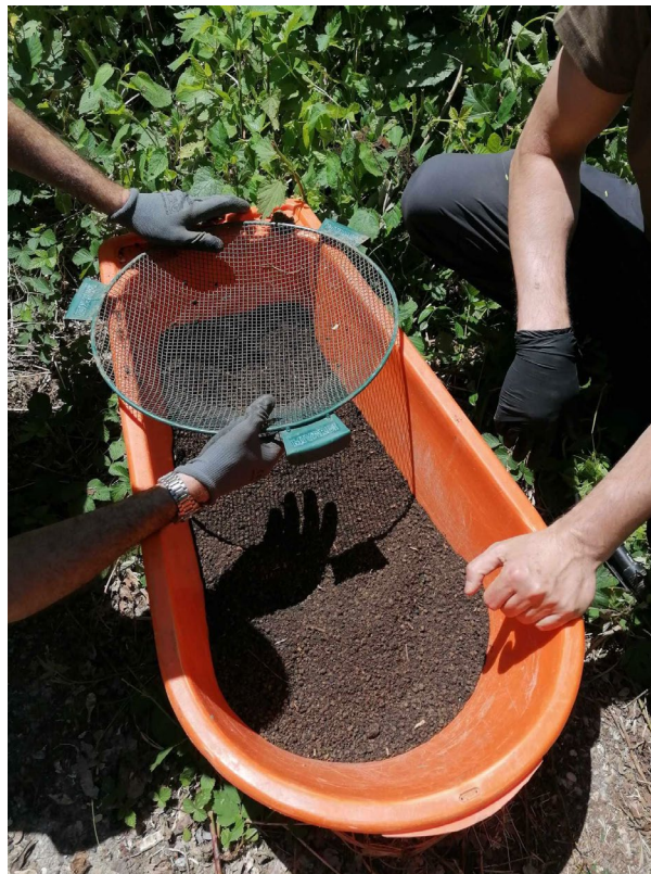
Obder vzoriek riečného sedimentu a pôdy z lokality Strážske. Vľavo: Potok, z ktorého sa odoberal riečny sediment - oblasť “pod prameňom”; vpravo: preosievanie kompozitnej vzorky pôdy.
