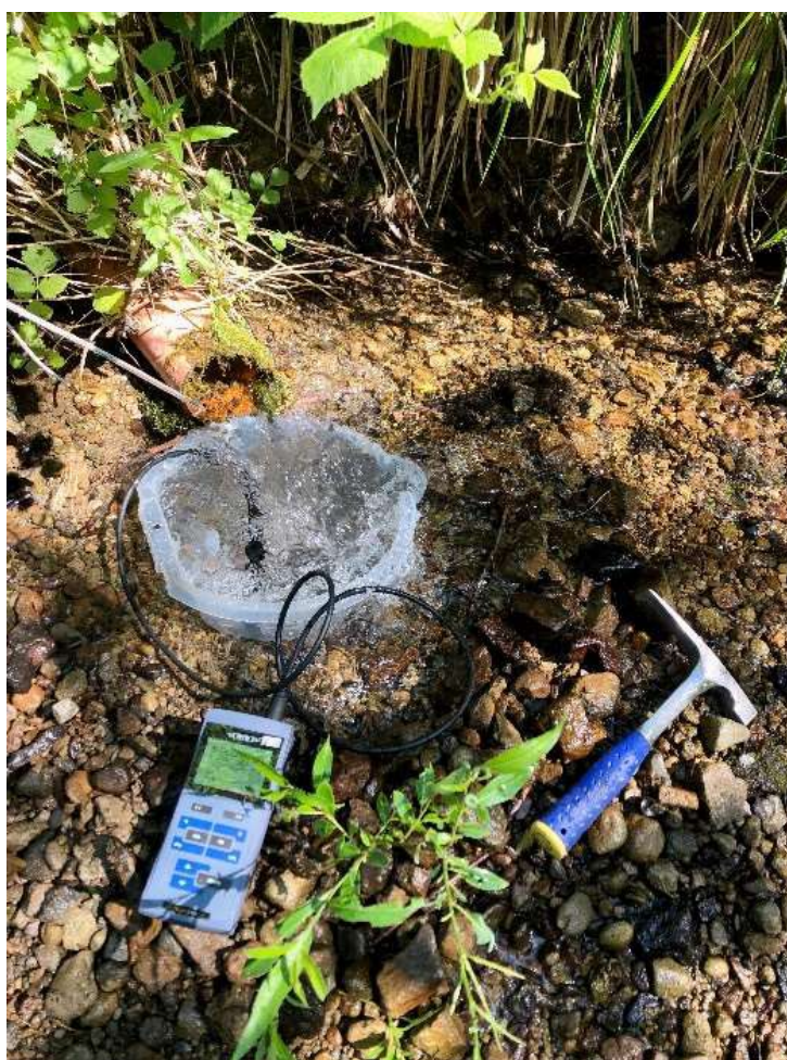
R. Dugovič: Meranie parametrov podzemnej vody
