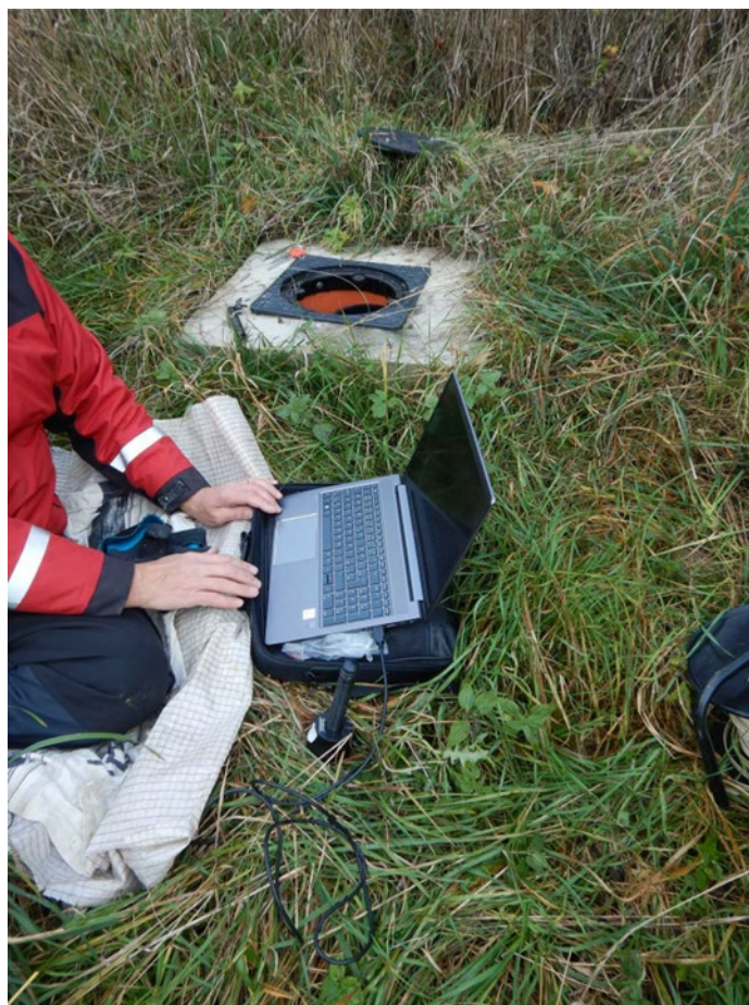
Odčítavanie záznamov z dataloggera inštalovaného vo vrte JS-2 na lokalite Sveržov
