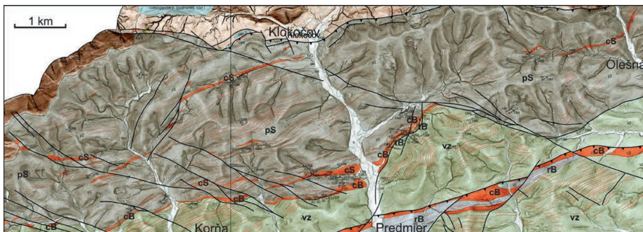
Obr. 14. V solánskom súvrství na Kysuciach sa zistili nové výskytý červených ílovcov (solánske súvrstvie: pS – lukovské vrstvy, cS – červené ílovce, rB – spodné belovežské vrstvy, cB – červené ílovce spodných belovežských vrstiev, tB – vrchné belovežské vrstvy, vz – vsetínske vrstvy).
