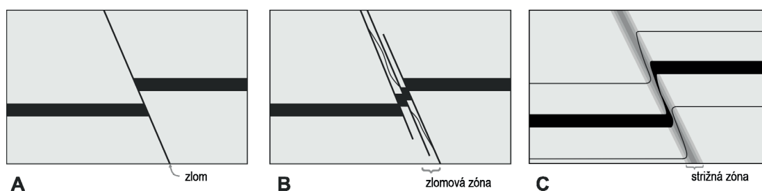
Obr. 24. A – Diskrétna plocha zlomu, B – systém súvisiacich zlomov tvoriaci zlomovú zónu, C – strižná zóna, v ktorej prebieha duktilná, resp. plastická deformácia.
