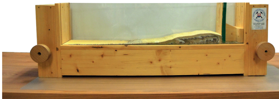
Obr. 14. Jednoduchý experimentálny sandbox model orogénneho klina (Štátny geologický ústav Dionýza Štúra, oddelenie vydavateľstva a propagácie; foto O. Pelech).
