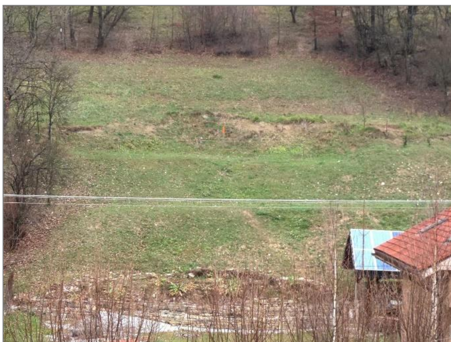
Plošná svahová deformácia vo svahu s výrazným sklonom na lokalite Lodno
