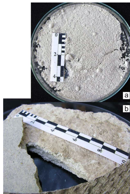
Obr. 1. Odstránenie karcinogénnych vlákien chryzotilového azbestu z eternitu umelou karbonatizáciou: neškodná substancia bez karcinogénnych vlákien s novovykryštalizovanými karbonátmi (a), vzniknutá po karbonatizácii termicky modifikovanej rozomletej strešnej eternitovej krytiny (b).
