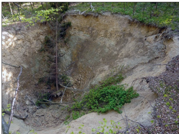
Obr. 5 (vľavo): Kráter s priemerom 20 m a hĺbkou 8 m vzniknutý závalom nadložia Novej štôlnie (foto Bajtoš, 3. 5. 2009).
