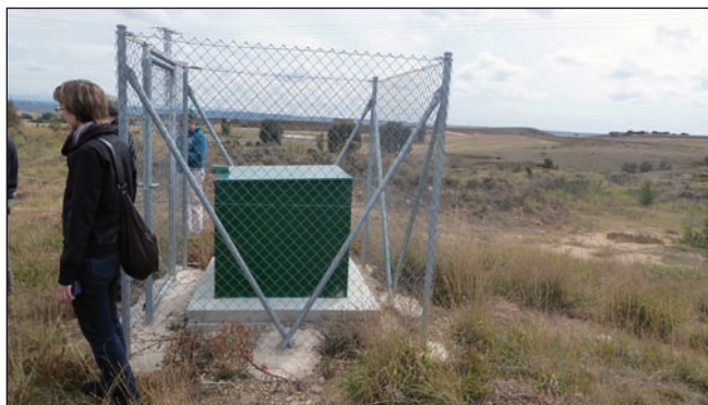
Obr. 4. Spôsob ochrany registračného zariadenia.
