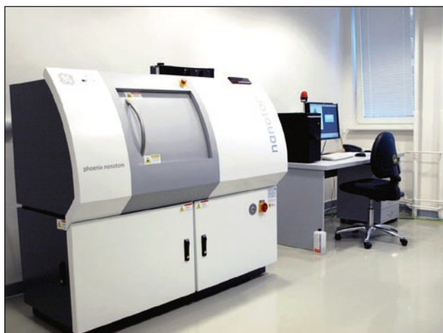
Obr. 2. Počítačový mikrotomograf Nanotom 180, umiestnený v Ústave merania SAV.
