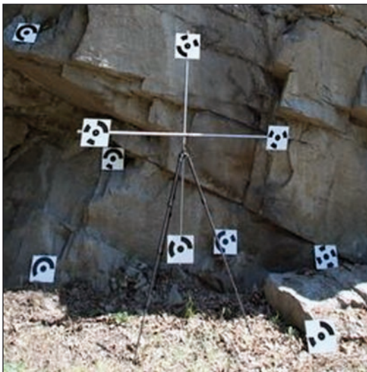
Obr. 5. Osový kríž na určenie orientácie skalného svahu voči svetovým stranám.
