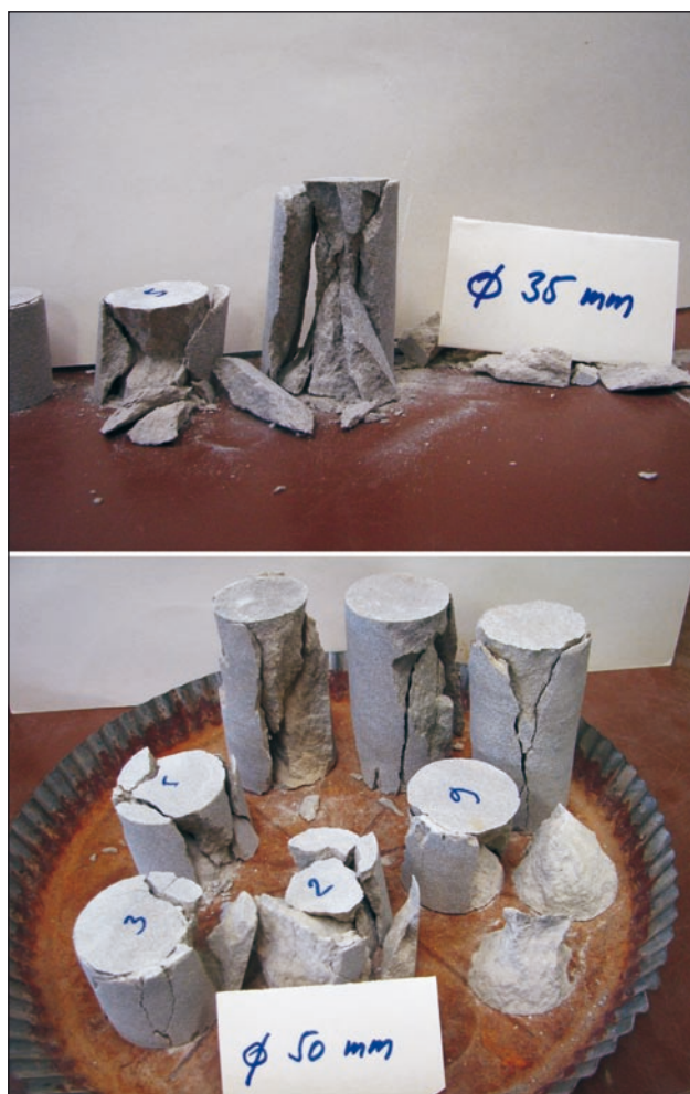
Obr. 8. Skúšobné telieska s priemerom 35 mm a 50 mm po tlakových skúškach.
