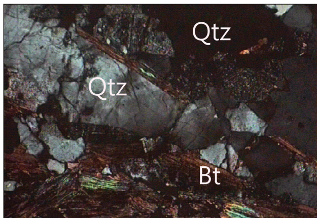
Obr. 5. Mikroštruktúry očkato-páskovaných ortorúl zo Starohorských vrchov (vzorka VHR-2/5P), skrížené nikoly, zv. 46x, ribón kremeňa.
