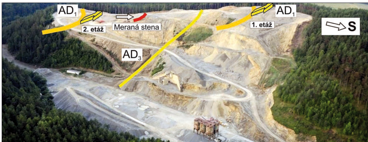
Obr. 2. Kameňolom Sedlice I. s vyznačením pozície meranej lomovej steny v severnej časti 2. etáže a základnými alpínskymi regionálnymi štruktúrami násunového deformačného štádia AD 1 a horizontálne posuvného štádia AD 3 . Vrstvovitost dolomitov je sklonená na sever pod miernym až stredným uhlom.
