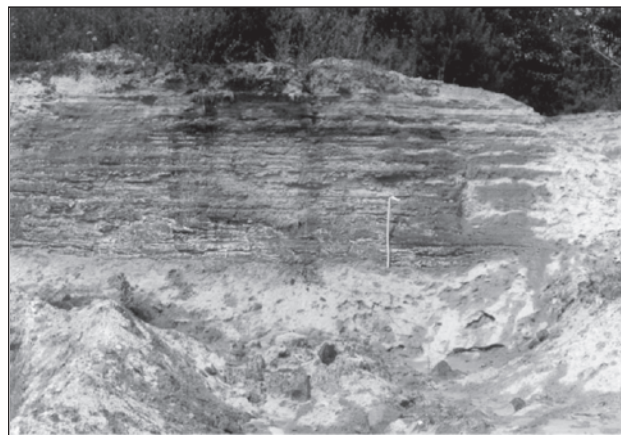
Obr. 5. Odkalisko Lintich. Čelná stena ťažobnej jamy s výkvetmi sírnych solí.
