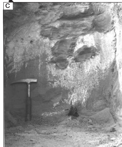
Obr. 6. Odkalisko Sedem žien (stav z júla 2003). a – zvrstvenie sedimentov vrcholovej časti náplavového kužela havarijného vtoku rmutu, b – čelo sondy vo svahu 7. etáže hrádze, c – výkveti sírnatých solí na čelnej strane sondy (b) po siedmich bezzrážkových dňoch od jej vyhlbenia.
