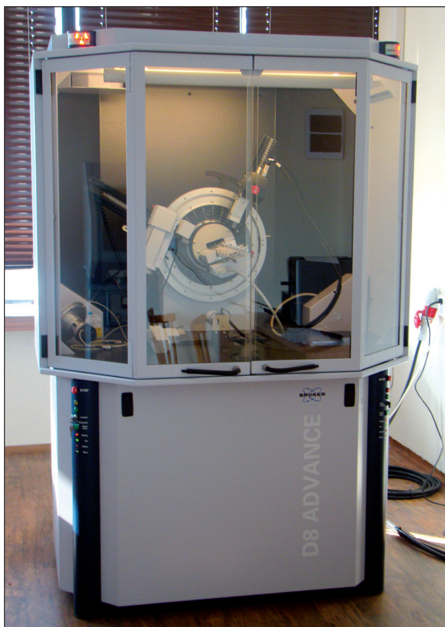
Difraktometer BRUKER D8 ADVANCE, inštalovaný v laboratóriu rtg. difrakcie na Prírodovedeckej fakulte Univerzity Komenského v Bratislave
