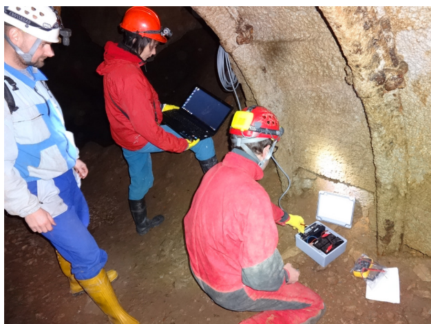
Obr. 9. Terénny zber výsledkov z poľného prietokového fluorimetra GGUN-FL30 vnútri Krásnohorskej jaskyne.
