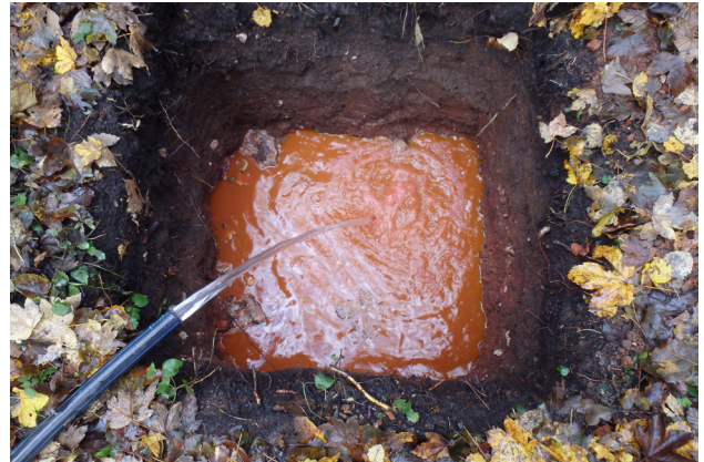
Obr. 6. Preprava čistej vody používanej na hydraulické zatlačenie stopovacej látky do horninového prostredia (a), hydraulické dotlačenie stopovacej látky (b).
