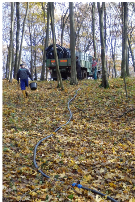
Obr. 7. Prívod čistej vody použitej na hydraulické zatlačenie stopovacej látky do horninového prostredia hadicou ku dnu závrtu (a), stopovač naftionát sodný v jame vyhlbenej na dne závrtu (A) (b).
