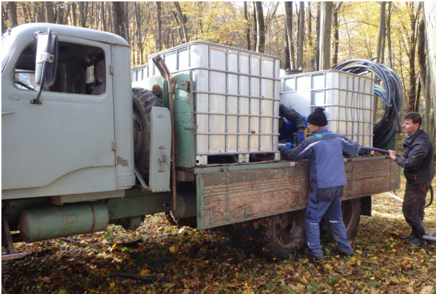
Obr. 6. Preprava čistej vody používanej na hydraulické zatlačenie stopovacej látky do horninového prostredia (a), hydraulické dotlačenie stopovacej látky (b).
