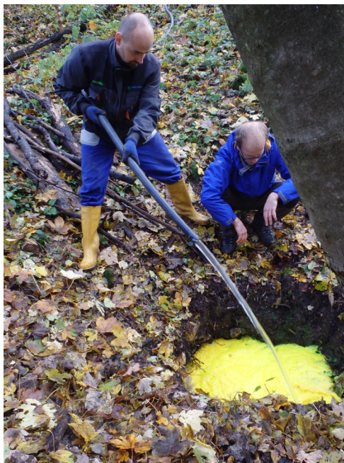
Obr. 4. Zapúšťanie stopovacej látky sulforodamín B na dne závrťu (C) (a), zatlačanie fluoresceínu na dne závrťu (B) dodatočným množstvom 2 m 3 čistej vody (b).
