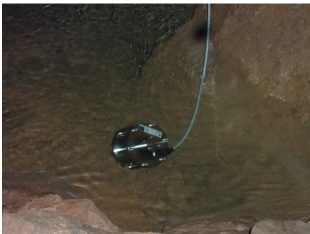
Obr. 8. Použitie kontinuálne pracujúceho poľného prietokového fluorimetra GGUN-FL30 – detailná ukážka detekčnej časti (a) a pamäťovej časti zariadenia slúžiaceho na zber údajov (b).
