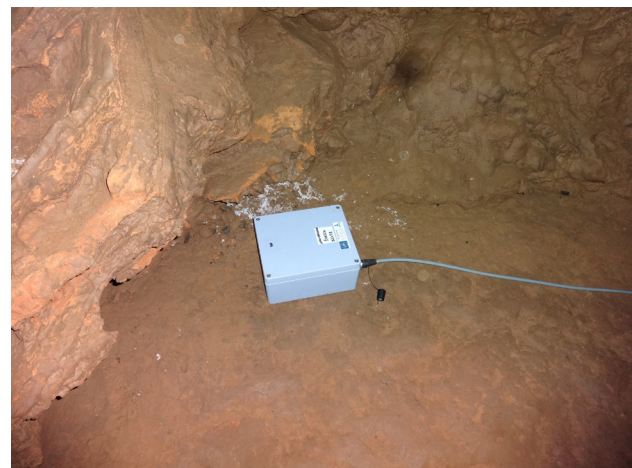
Obr. 8. Použitie kontinuálne pracujúceho poľného prietokového fluorimetra GGUN-FL30 – detailná ukážka detekčnej časti (a) a pamäťovej časti zariadenia slúžiaceho na zber údajov (b).
