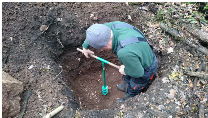
Obr. 3. Úprava miest aplikácie stopovacích látok na dnách závrto: a) hĺbenie jamy v závrte (D), b) navŕtavanie dna jamy zemným vrtákom v závrte (D).
