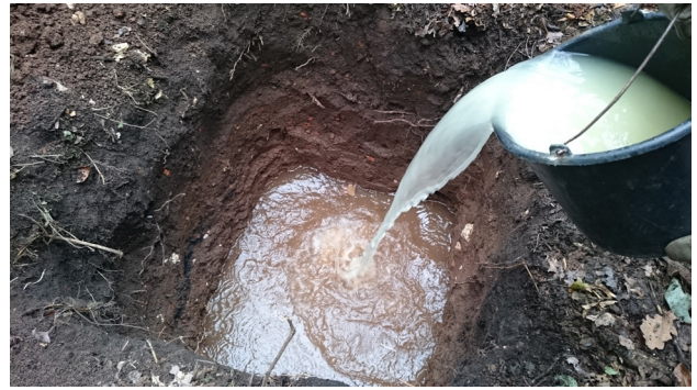
Obr. 5. Suspenzia bakteriofágov H40/1 po preprave na lokalitu (a), aplikácia fágovej suspenzie do jamy vyhlbenej na dne závrtu (D) 14. 11. 2016 (b).
