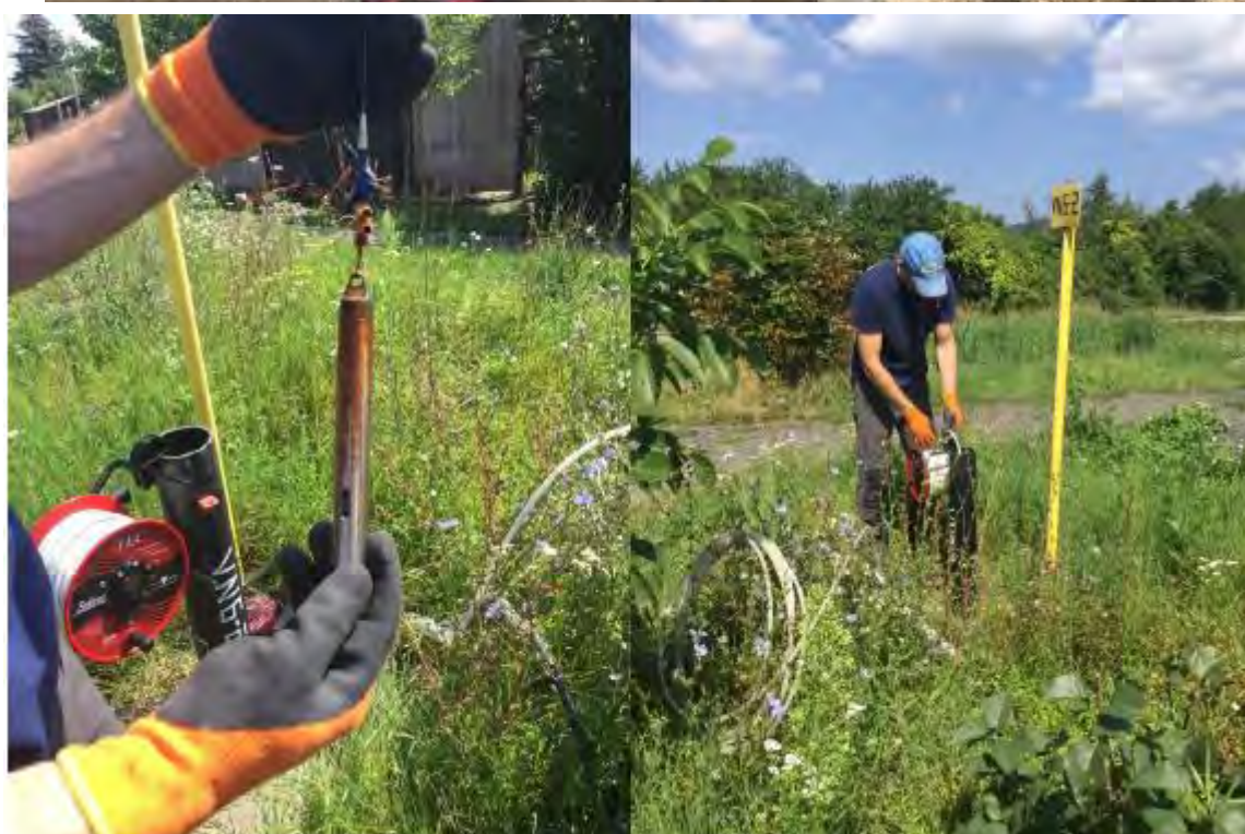
Odbery podzemných vôd v pilotnom území Bratislava – Hainburg, meranie tepelnej odozvy vo vrtoch, meranie tepelnej vodivosti zemin in-situ
