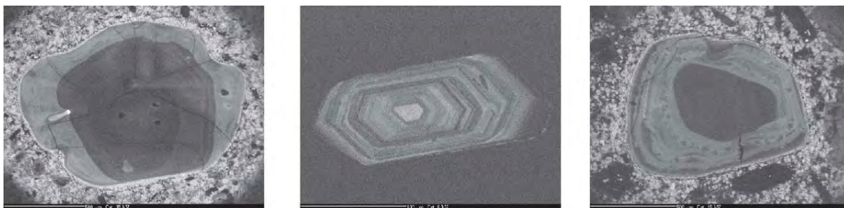
Obrazy katódoluminiscencie (CL) – sledovanie prírastkových zón v chemicky homogénnych materiáloch a mineráloch
