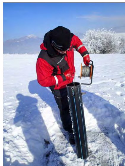
Kontrola zabudovania inklinometrického vrtu na lokalite Liptovská Štiavnica
