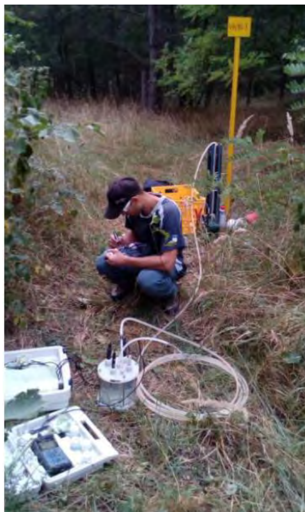
Terénne merania a odber vzorky podzemnej vody z vrtu VN90-1 (lokalita Banská Štiavnica – odkalisko Lintich)
