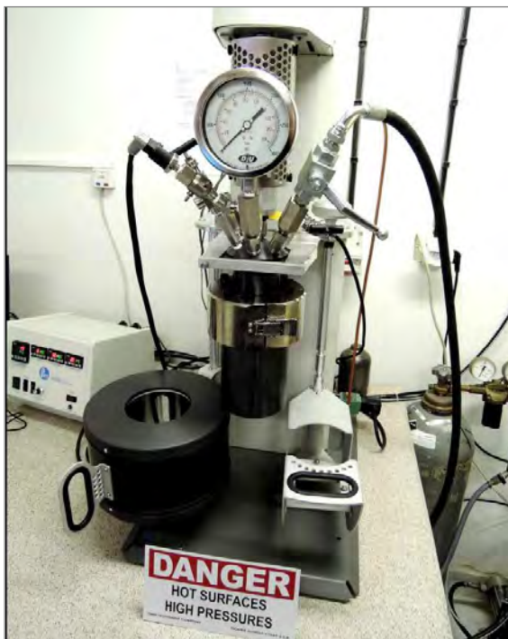
Vysokotlakový reaktor PARR 4540 umožňuje počítačovú registráciu reakčných parametrov (tlak, teplota, otáčky) a programovanie parametrov exotermických a endotermických reakcií.
