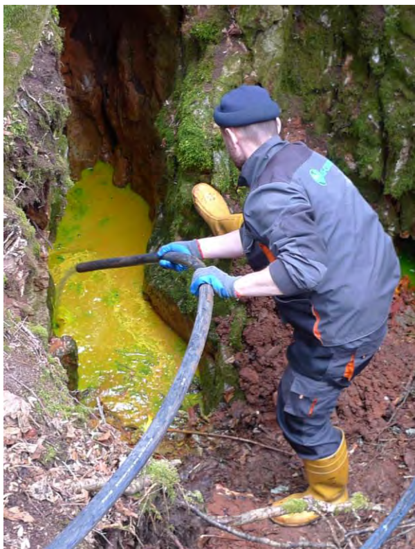
Realizácia jednej zo stopovacích skúšok v krasových priepastiach a prepadliskách v oblasti Krásnohorskej jaskyne dňa 13. 04. 2017 – stopovacia látka uranín / Na-fluoresceín
