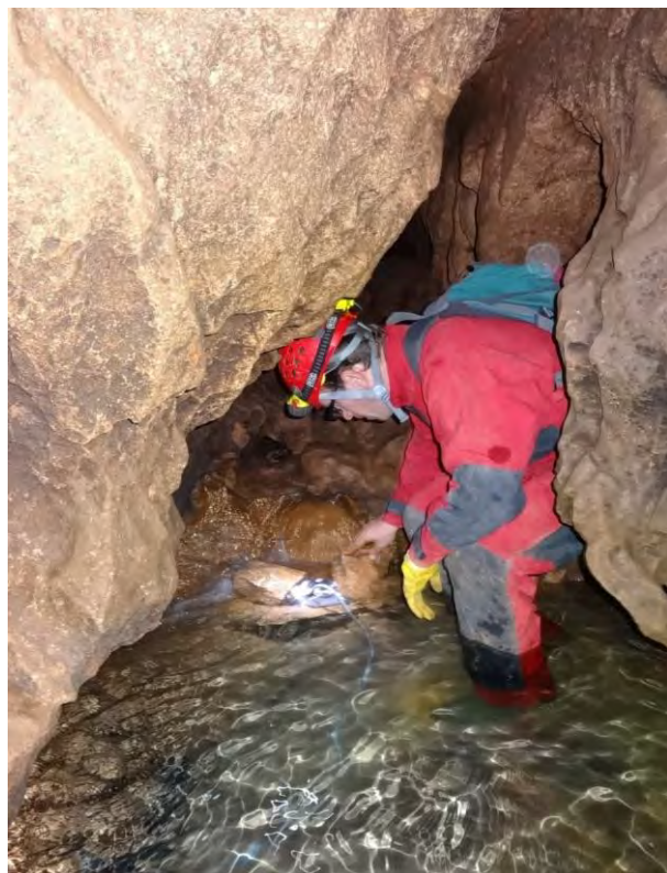
Použitie poľného fluorimetra GGUN FL30 počas realizácie stopovacích skúšok – prítok od Heliktitového dómu / pod Veľkou sieňou v Krásnohorskej jaskyni
