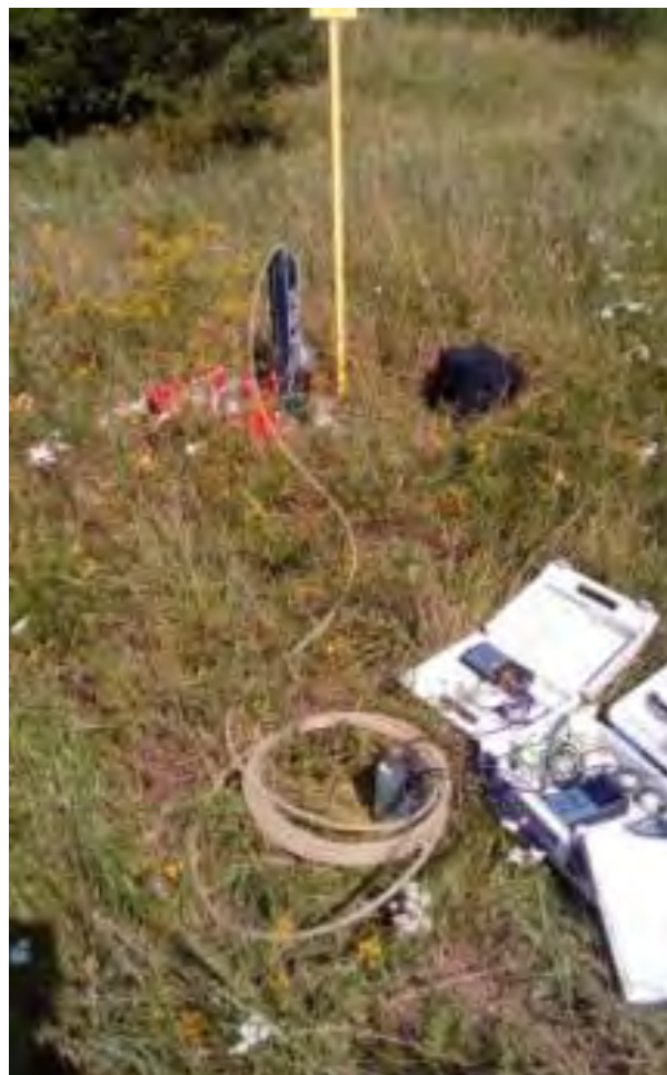
Kontrola zariadenia na kontinuálne meranie hladiny a teploty podzemnej vody (lokalita Banská Štiavnica - odkalisko Lintich)
