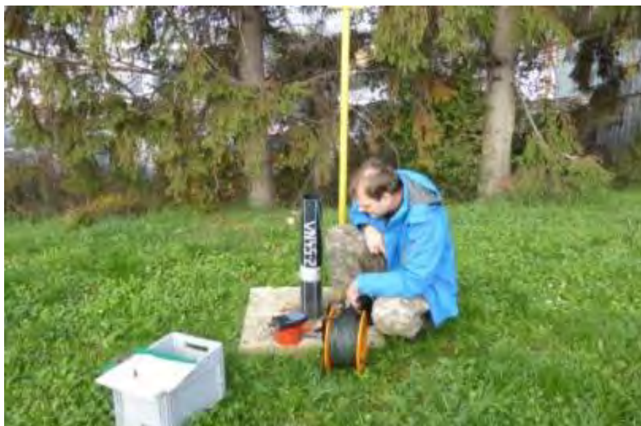
In situ merania ukazovateľov (pH, EC, teplota, O 2 ) hĺbkovou sondou vo vrte VN45-2 (lokalita Žiar nad Hronom - ZSNP - areál skupiny spoločností)
