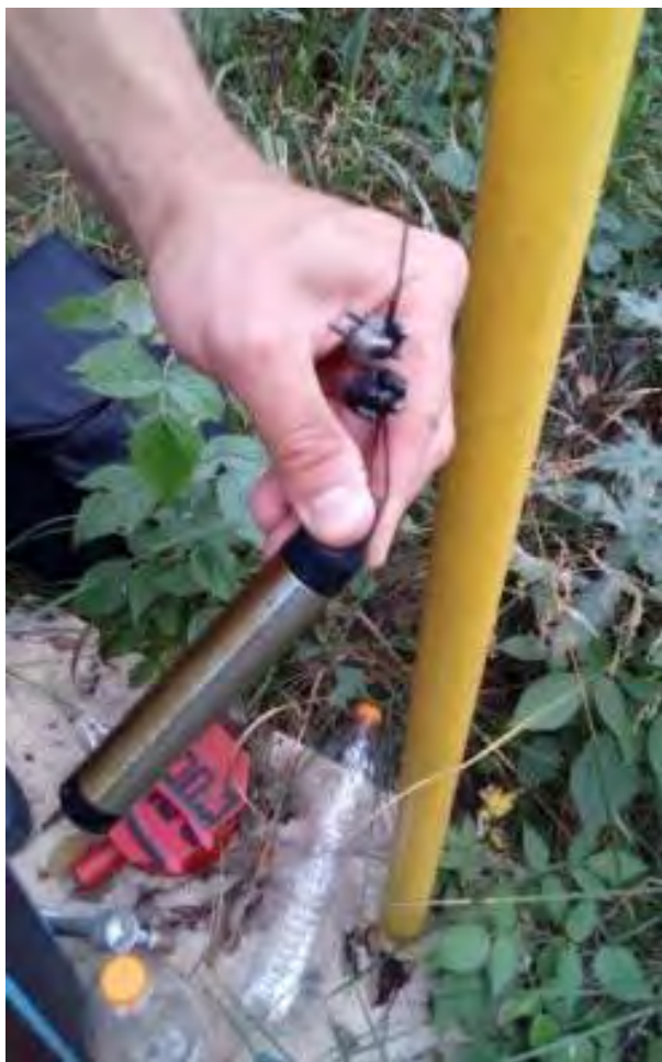
Terénne merania a odber vzorky podzemnej vody na chemickú analýzu z vrtu VN152-2 (lokalita Banská Belá - odkalisko Sedem žien)
