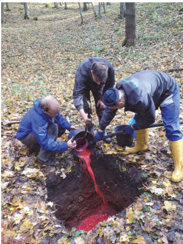
Realizácia jednej zo stopovacích skúšok na dnách závrtovej nad Krásnohorskou jaskyňou dňa 26. 10. 2016 – stopovacia látka suforodamín
