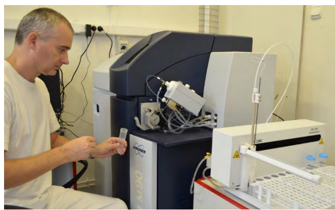
Optická emisná spektrometria s hmotnostnou detekciou – ICP MS – Aurora M 90 Bruker
