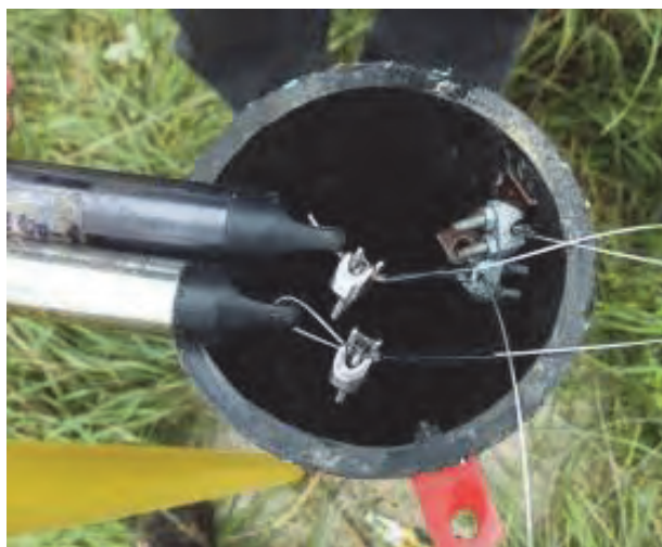
Revízia dataloggra Solinst a barologgra Solinst vo vrte VN100-1
