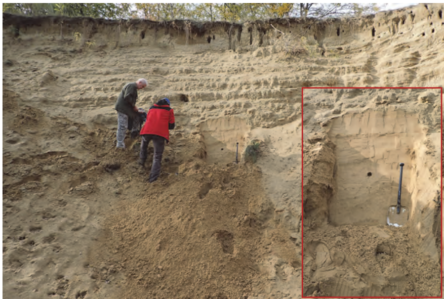
Príprava odkryvu pre odber vzorky na stanovenie absolútneho veku eolických pieskov presypu v Nesvadoch. Vpravo detail miesta odberu.
