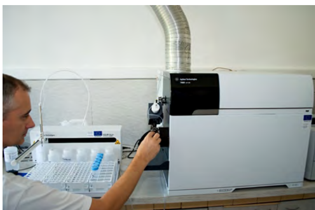
Hmotnostný spektrometer s indukčne viazanou plazmou Agilent 7900 ICP MS - stanovenie anor- ganických látok vo vodách a tuhých vzorkách
