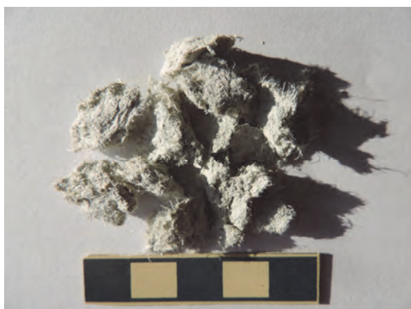
Vzorka odpadu s obsahom chryzotilu pred karbonatizáciou (lok. Košice)
