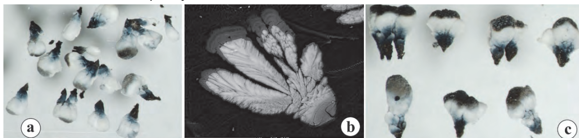
Habitus jednotlivých kryštálikov kovového horčíka a ich zrastov. Iný typ vetvenia už od spodných častí rastu kryštálikov. Zreteľný najmä na BSE obrázkoch
