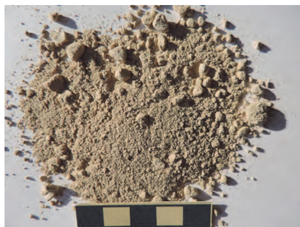
Vzorka odpadu po karbonatizácii bez vlákien chryzotilu (lok. Košice)
