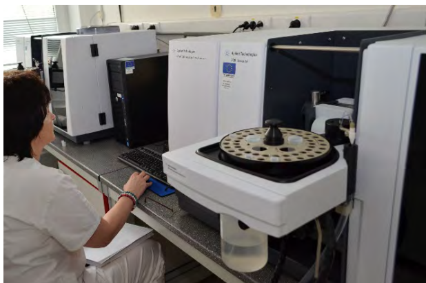
Atómová absorpčná spektrometria Agilent AA Duo 240FS/240Z/UltraAA System
