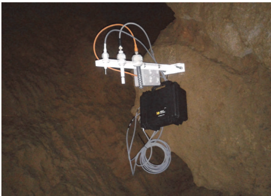
Jedno z piatich inštalovaných monitorovacích zariadení pre sledovanie parametrov vzduchu v Krásnohorskej jaskyni – poloha pri jaskynnom vstupe
