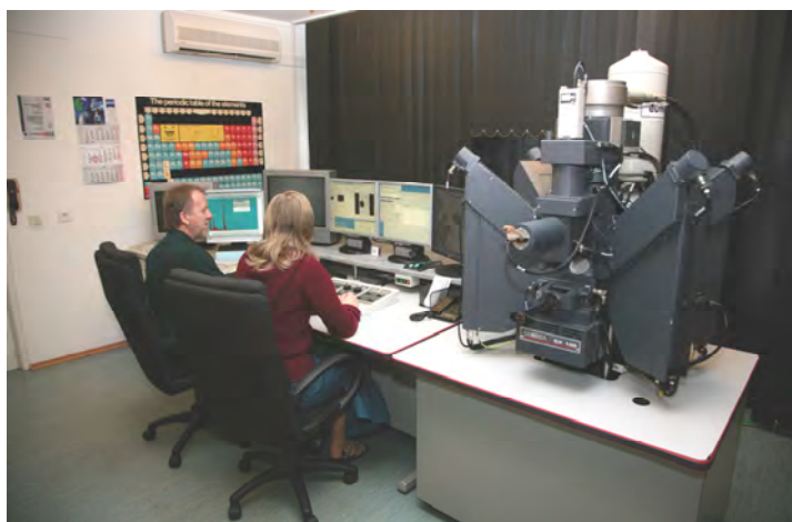
Elektrónový mikroanalyzátor Pomocou štyroch spektrometrov umožňuje získavať chemické analýzy prvkov od bóru po urán
